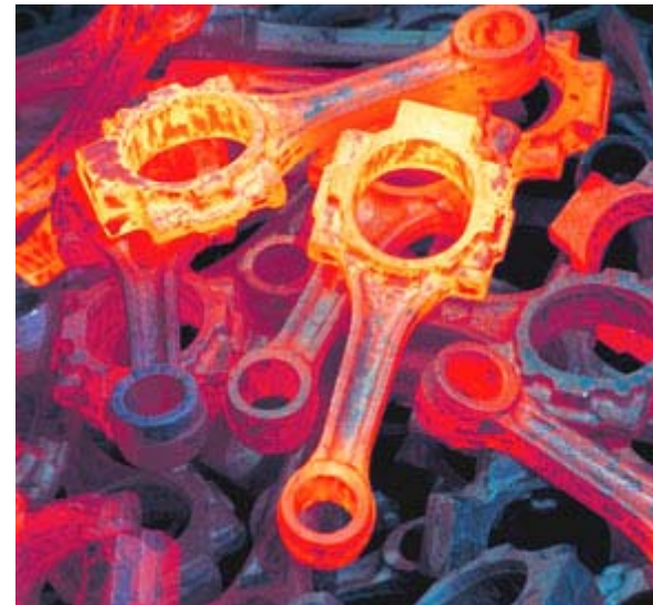
FORJA EN CALIENTE DE BIELAS PARA EL AUTOMÓVIL
